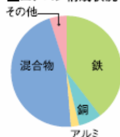
■エアコン構成状況
